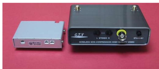
小型送信モジュール 受信ユニット: GTV-R1 2.4GHz帯: GTV-24TMS (音声無し)
